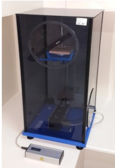
Fig. 5. König pendulum hardness.
